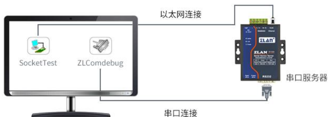
图 11 TCP 通讯示意图
