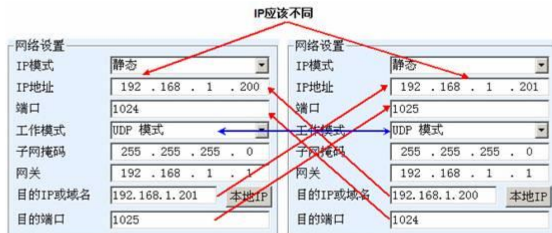
图 22 UDP 设备对联参数配置
