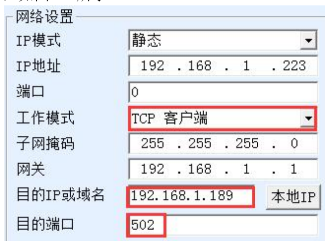
图 11 Modbus TCP 做客户端。
