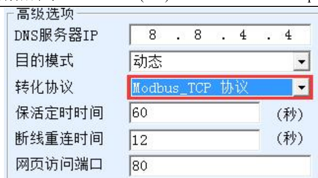
图 15 启用 Modbus TCP 功能
