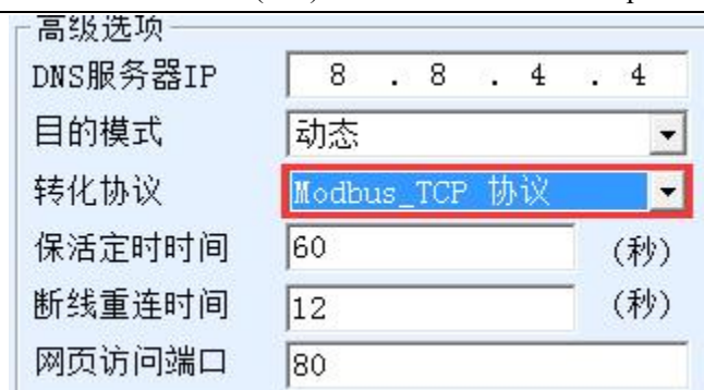
图 23 启用 Modbus TCP 功能
