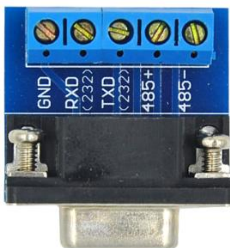
图 4 DB9 到端子转接板
