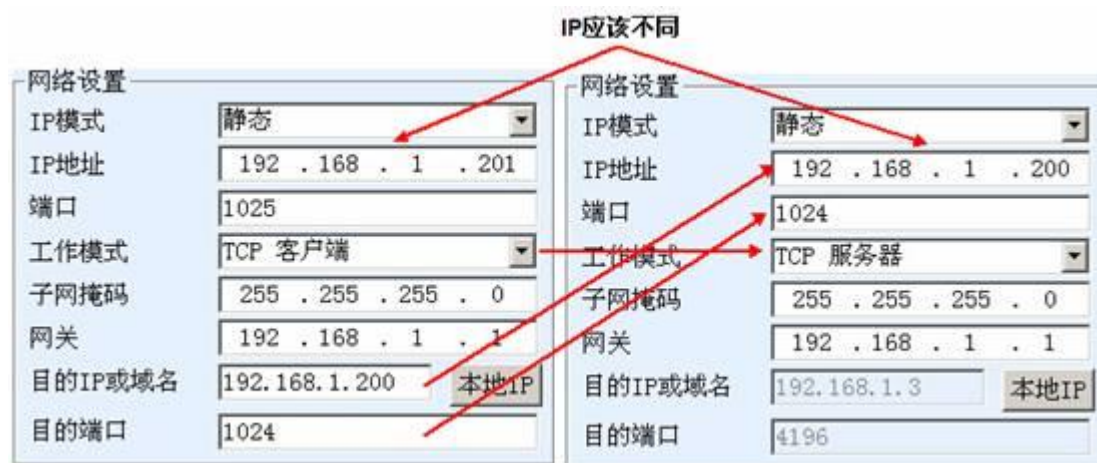
图 32 TCP 设备对联参数配置
